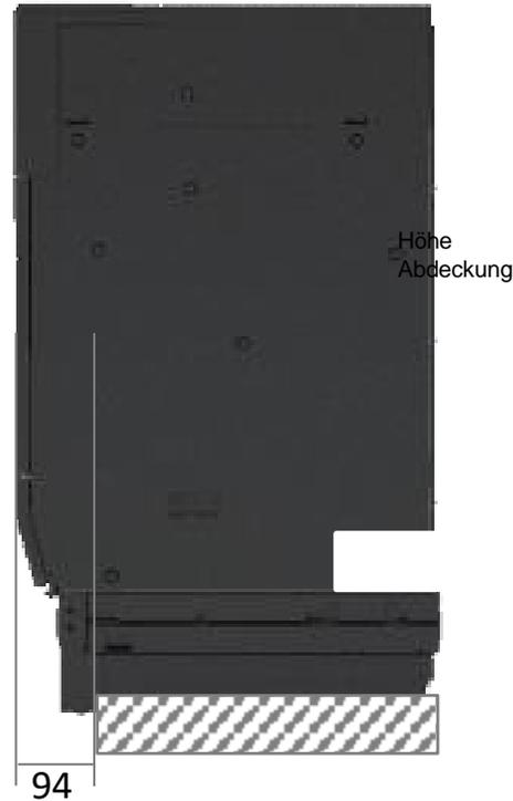
Der Abstand des Sockels (Typ M) bis zur Frontabdeckung des Bezahlautomaten beträgt etwa 94 mm. Dies muss bei der Ausrichtung und Verankerung berücksichtigt werden.
